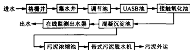
图 1 废水处理工艺流程
