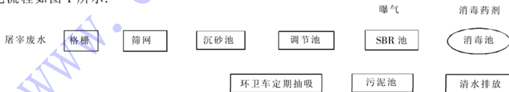
图 1 废水处理工艺流程图
