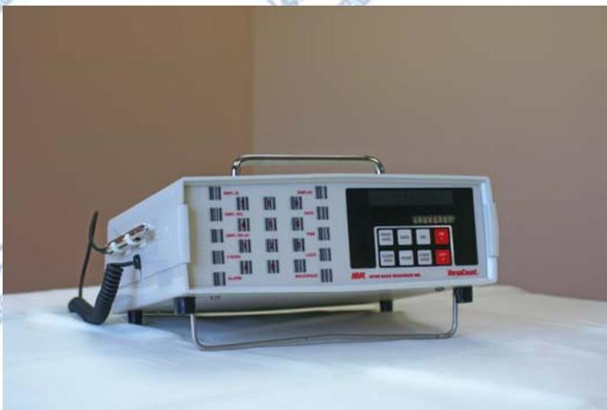
图8 台式激光颗粒物分析仪
