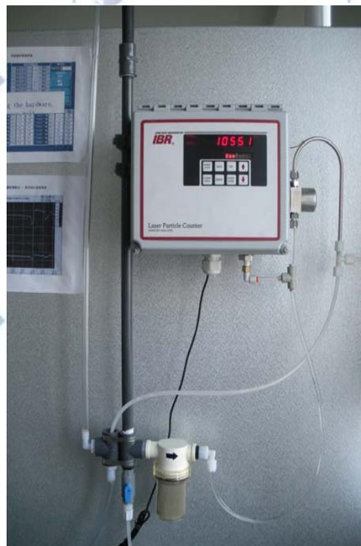
图9 在线式激光颗粒物分析仪
